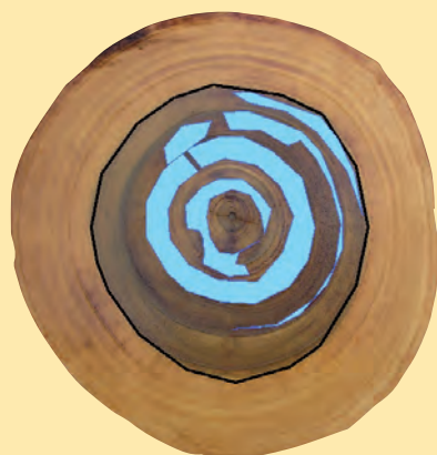
Rondelle test bois de tension (couleur bleue) et mesure du taux de faux-cœur (limite trait noir)
