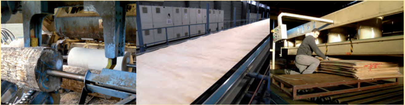
Vues d'un billon en cours de déroulage, du ruban en sortie dérouleuse et de l'empilage après massicotage
