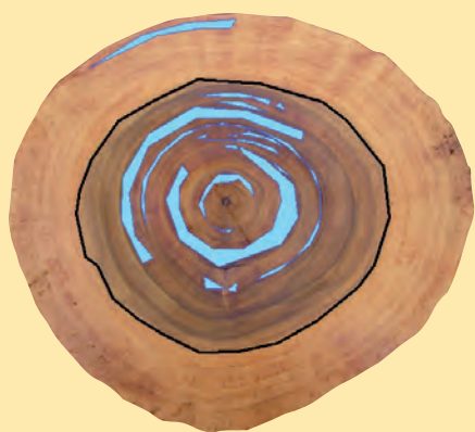
Rondelle test bois de tension (couleur bleue) et mesure du taux de faux-cœur (limite trait noir)
