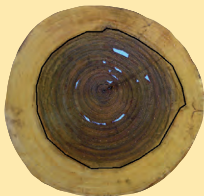
Rondelle test bois de tension (couleur bleue) et mesure du taux de faux-cœur (limite trait noir)
