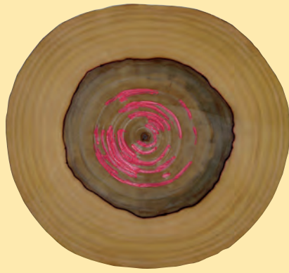
Rondelle test bois de tension (couleur verte ou rouge), mesure bois de cœur/aubier (limite en trait noir)
